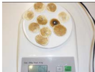
Pesée des 10 filtres en fin de manipulation (une cigarette utilisée pour chaque filtre)
